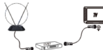
(рис. 2) Подключение через DVB-T2 приемник
