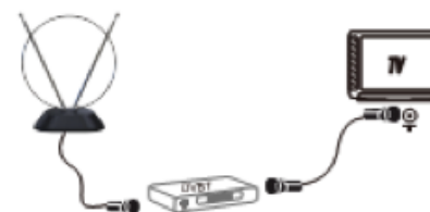
(рис. 2) Подключение через DVB-T2 приемник
