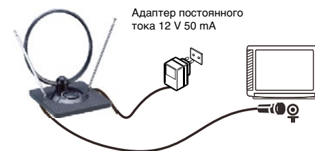
(Рис. 1). Прямое подключение к телевизору
