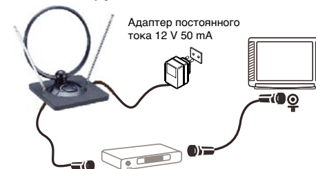
(Рис. 2). Прямое подключение к телевизионной приставке
